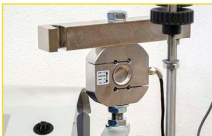
Possibilità di alloggiare celle di carico con capacità diverse, oltre alla cella standard da 10 kN
