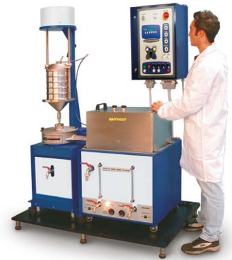
B008 UNITE D'EXTRACTION AUTOMATIQUE DES BITUMES
