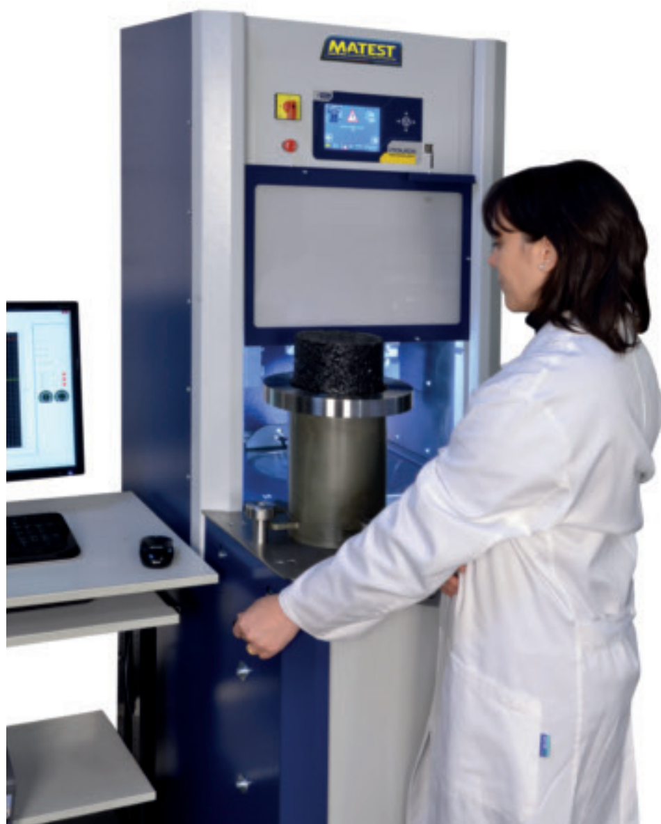
Esecuzione della prova con sforzo di taglio
