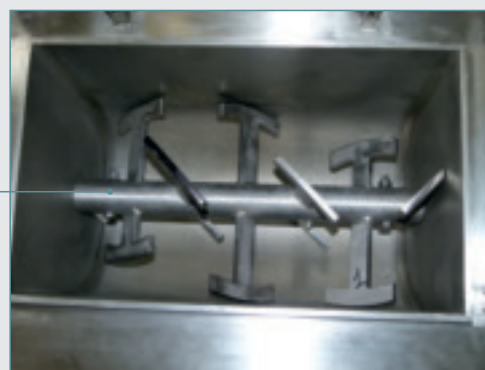
Dettaglio: lame elicoidali di miscelazione
