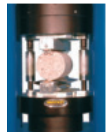
Trazione indiretta su cubi e cilindri di calcestruzzo
