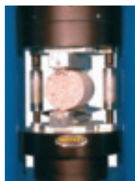
Frazionamento di cubi e cilindri di calcestruzzo
