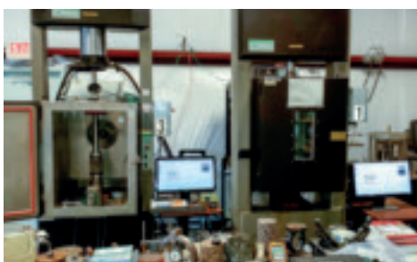
Sistema UTM Interlaken aggiornato da Pavetest, AAT, USA.
