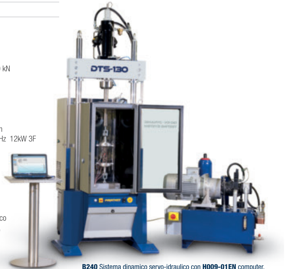
B240 Sistema dinamico servo-idraulico con H009-01EN computer, B231 armadio a temperatura controllata, B240-03 scambiatore olio/acqua, centralina HPS
