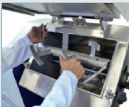
B026-05N Dettaglio dell'albero di miscelazione con lame elicoidali staccabili
