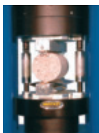
Frazionamento di cubi e cilindri di calcestruzzo
