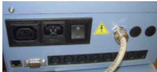
Uscita seriale RS232 per connessione a PC e connessione LAN a Internet
