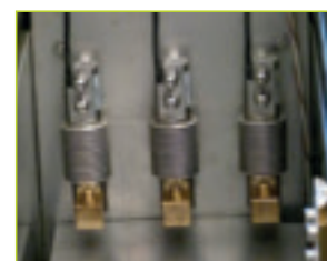
Dettaglio: 3 celle di carico da 500 N
