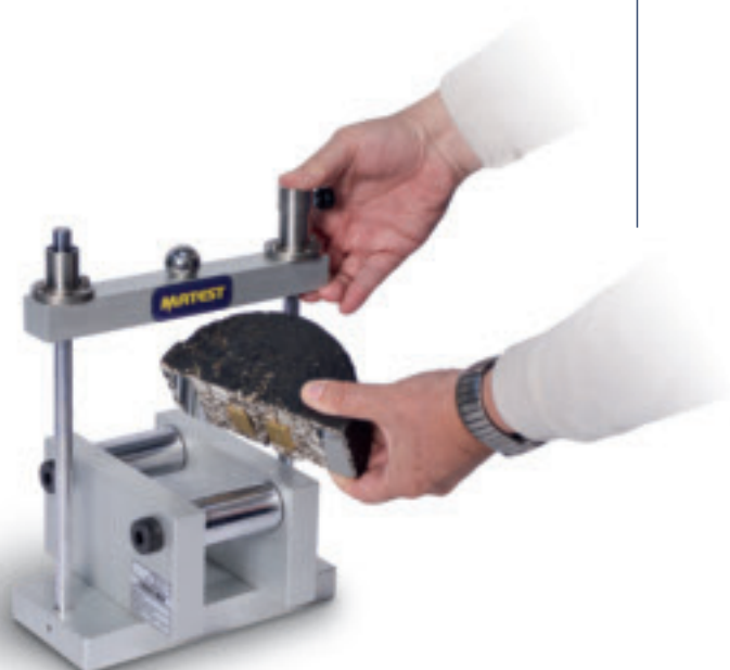
Posizionamento del campione di asfalto
