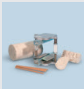
TRAZIONE INDIRETTA DEI CILINDRI DI CALCESTRUZZO
