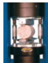
Trazione indiretta su cubi e cilindri di Calcestruzzo
