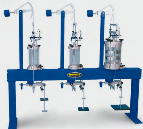
S359 Marco de consolidación para muestras triaxiales
