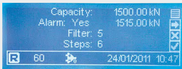
Ajuste de alarma para carga máxima
