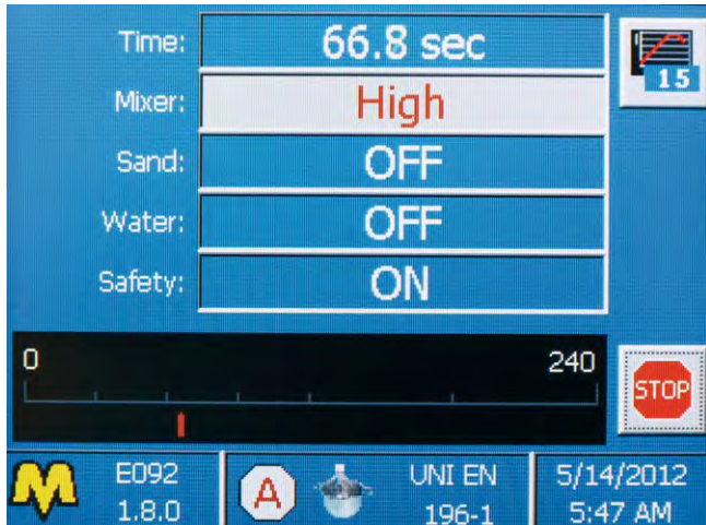
Pantalla durante ejecución de la prueba
