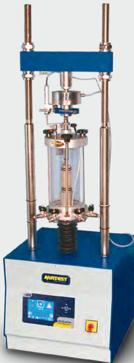
S301N Ensayos triaxiales UU - CU - CD
