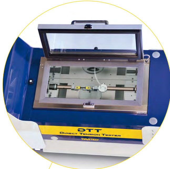
B225-09 DTT Ensayo de tracción directa
