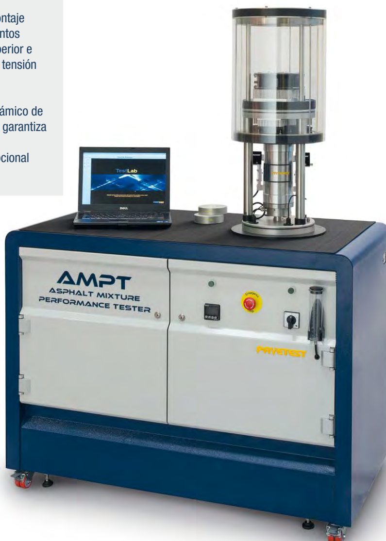
B200 AMPT/SPT equipo para evaluación del desempeño de mezclas asfálticas
