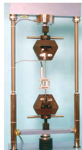
S205-05N + accesorios para prueba de tracción
