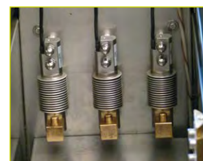
Detalle: 3 celdas de carga 500 N
