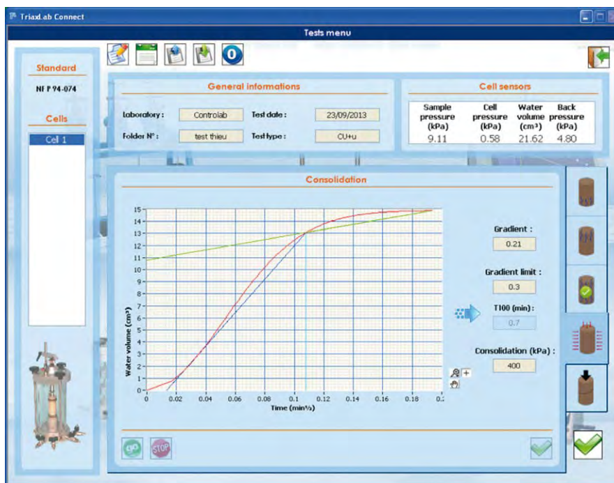
S335-10N Etapa de consolidación en TriaxLab Connect
