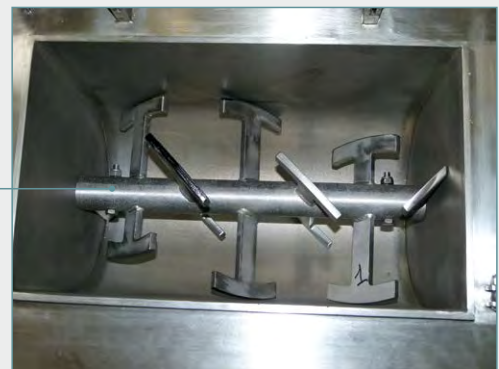
Detalle del eje de la mezcladora con cuchillas helicoidales
