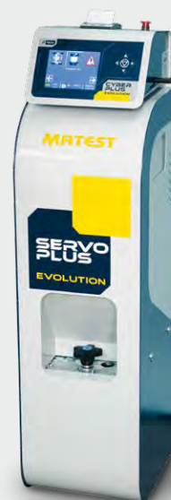
C109N Cyber-plus + C104-06 consola + C099N inverter + C114 unidad de bombeo
