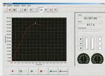
C109-11N Software para ensayo de flexión en probetas prismáticas de mortero
