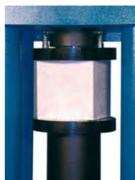
Compresión en Concreto
