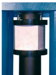
Compresión en concreto
