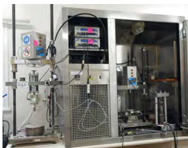
Sistemas UTM5P y UTM14P IPC Global actualizados por Pavetest, Fulton Hogan, Australia.
