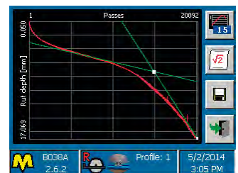
Resultados en tiempo real del gráfico de la profundidad junto con el número de pasadas
