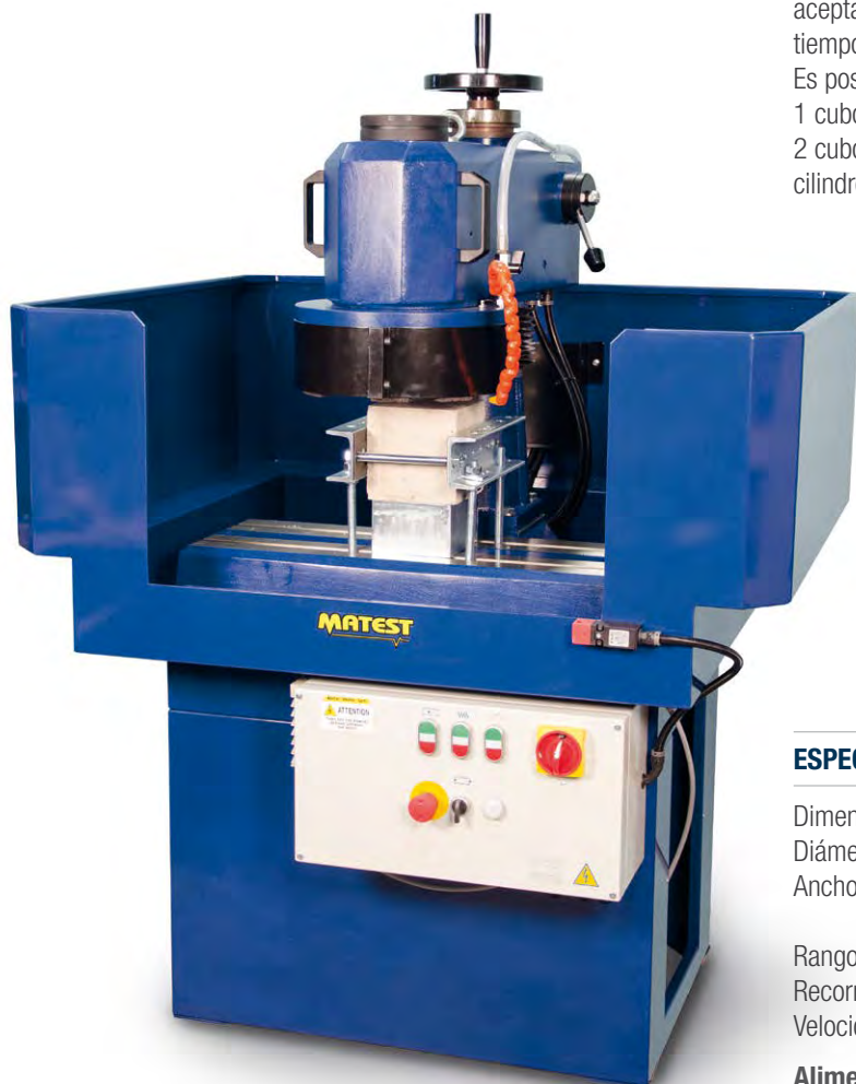
C299 con C300-06N sosteniendo un cubo de 150 mm
