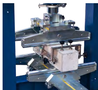
C090-15 + C109-15N fijados en la máquina de flexión C090-07N
