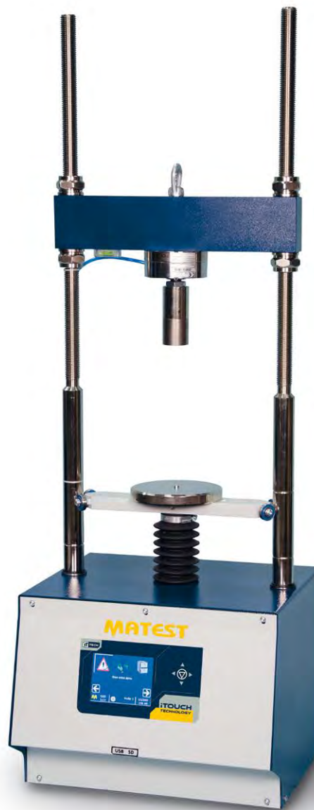
S205N con celda de carga
