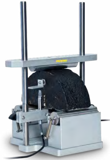
B254-02 KIT Kit de prueba SCB AASHTO TP124 | ASTM D8044
