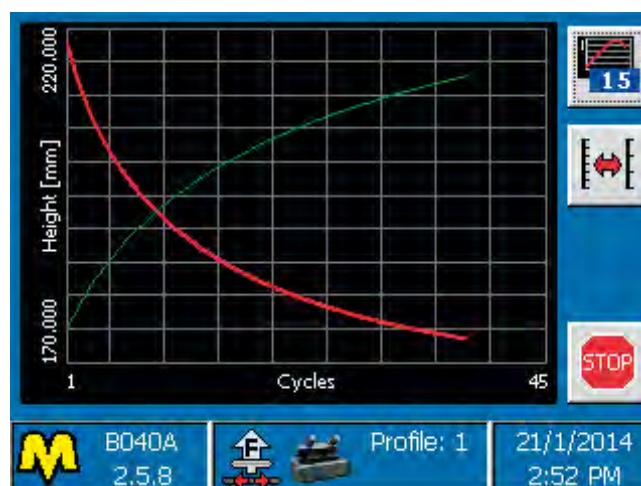
Gráfica de Ciclos por altura y Ciclos por densidad durante la compactación
