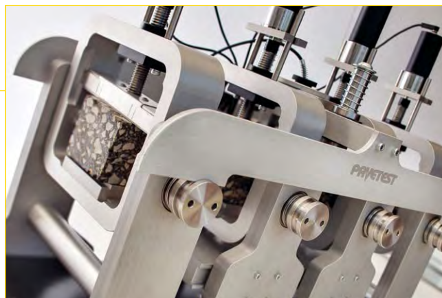
B210-01 Aparato servo-neumático de cuatro puntos, detalle
