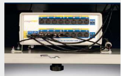
B206 16-ти канальный CDAS внутри корпуса
