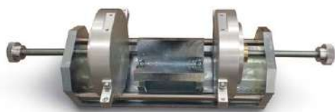
B282-08 TSRST Приспособление для приклеивания (необходимая принадлежность)
