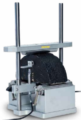
B254-02 KIT AASHTO TP124 | ASTM D8044 SCB изгиб полуцилиндров
