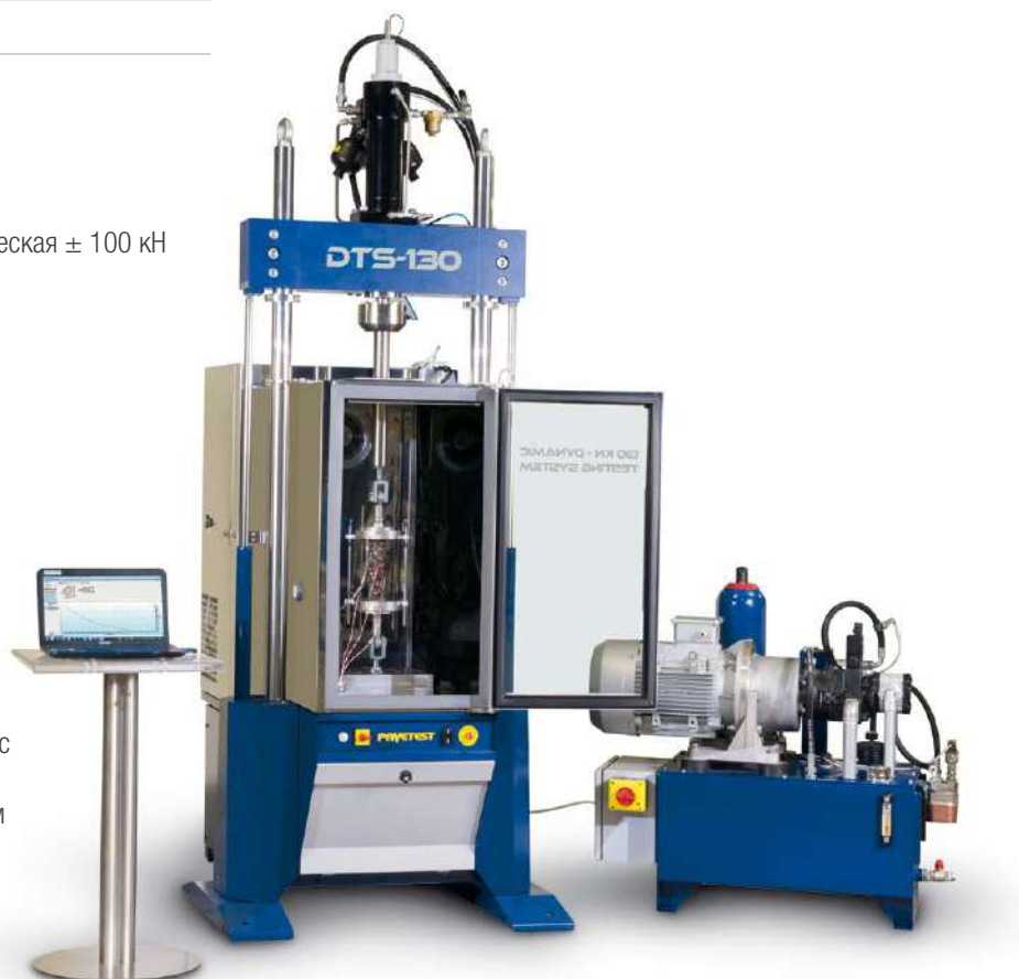
B240 сервогидравлическая динамическая система с термостатирующим блоком V231 , ПК в комплекте H009-01 EN и гидравлической системой V240-03 с водяным охлаждением масла
