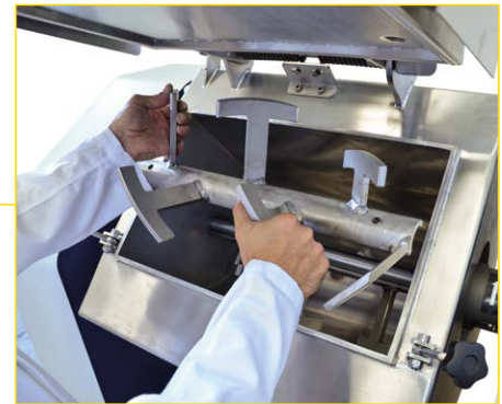
Dettaglio delle lame elicoidali smontabili
