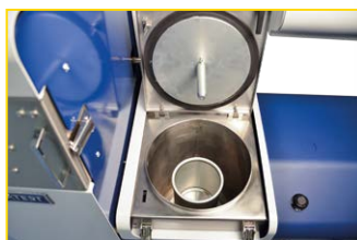
Provetta nella centrifuga, fino a 8000 giri al minuto
