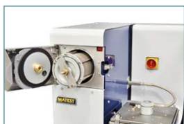
Tambor de malla en la cámara de lavado
