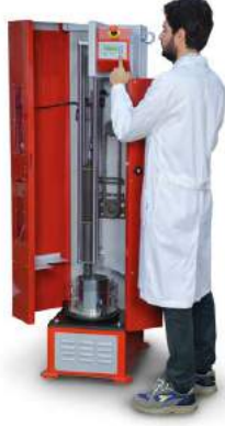
S199T OTOMATİK PROKTOR CBR KOMPAKTÖR TECNOTEST MODELİ
