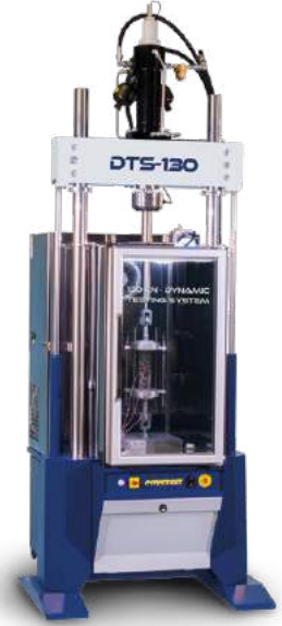
B240 130 KN SERVO-HİDROLİK DİNAMİK TEST SİSTEMİ (DTS-130)
