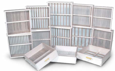
A023-01N TAMICES DE BARRAS (REJILLAS) ÍNDICE DE LAJAS DEL AGREGADO Y LA FORMA DE PARTÍCULAS
