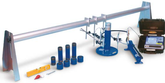
S224-01 KIT EQUIPO DE ENSAYO DE PLACA DE CARGA DIGITAL 200 KN DE CAPACIDAD
