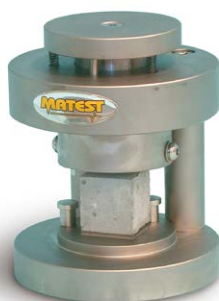
E170 DISPOSITIVO DE COMPRESIÓN PARA MUESTRAS DE MORTERO
