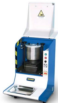
B007 SEPARADOR DE ASFALTO
