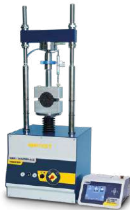
B043 KIT ESTRUTURA DE COMPRESSÃO MARSHALL DIGITAL CAPACIDADE DE 50KN
