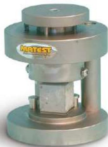
E170 EQUIPAMENTO PARA ENSAIO DE COMPRESSÃO EM AMOSTRAS DE ARGAMASSAS
