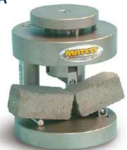
E172-01 EQUIPAMENTO PARA ENSAIO DE FLEXÃO EM AMOSTRAS DE ARGAMASSA
