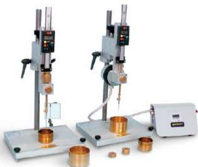
B077 KIT APARELHO PARA FRAGILIDADE DE FRAASS
