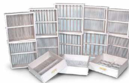
A023-01N PENEIRAS DE BARRAS (GRADES) INDICE DE ACHATAMENTO DO AGREGADO E FORMA DE PARTÍCULA
