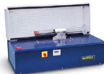
S160-01N AGITADOR DO EQUIVALENTE DE AREIA MOTORIZADO
